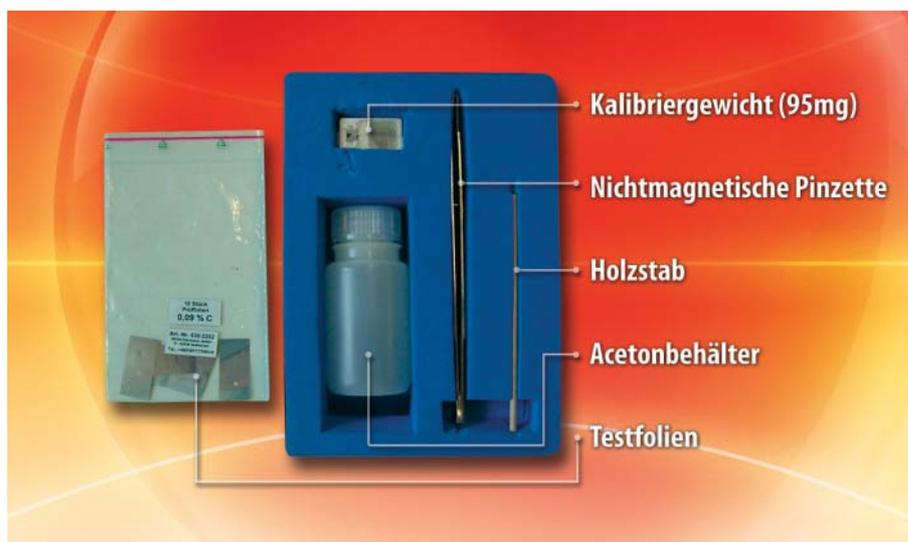
Bild 7: Zubehör für Folienprüfgerät FPG 1.0
