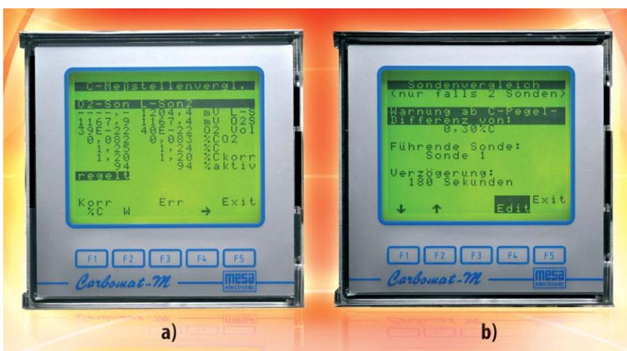
**Bild 2:** C-Potenzial-Regler Carbomat-M: a) Vergleich von zwei parallel arbeitenden Sonden; b) Menü zum Einstellen der Parameter für die Sondenumschaltung
