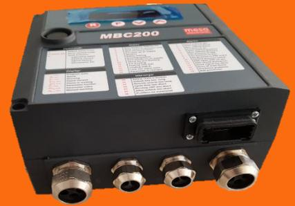
Brennersteuerung mit integriertem Zündtransformator, erweiterten Parametrierfunktionen und Luftsteuerung, in robustem Aluminiumgehäuse IP54, mit optionaler PC-Software für Konfiguration und Diagnose. Profibus-Schnittstelle, mit zusätzlichen E/A für Kundenanwendungen.
